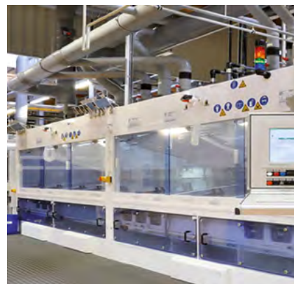
Anlage aus SIMONA® PVC CRP-1 FM 4910 und SIMONA® Clear PVC 2000
